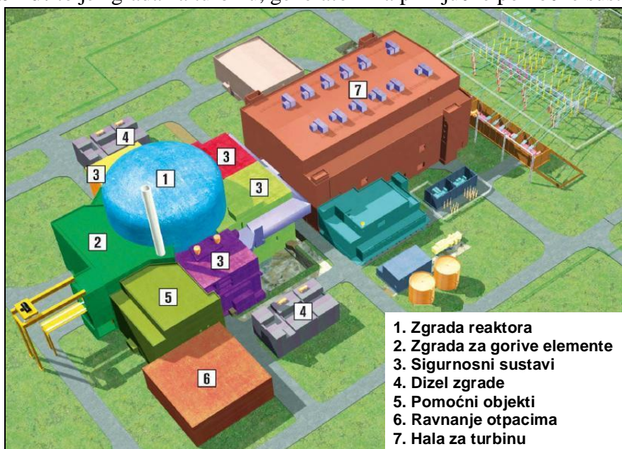
Slika br. 2.2.2.5-1.: Važnije zgrade EPR reaktorbloka [5]
