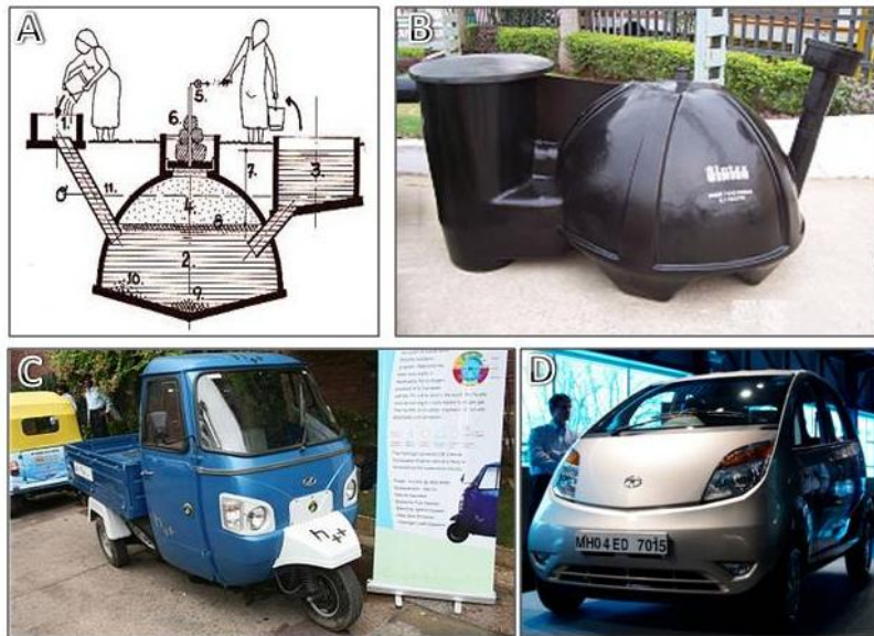
30. ábra Egy indiai családi méretű biogázfejlesztő „folyamatábrája” (A) és a kereskedelemben kapható modernizált változata (B). Hidrogénhajtású háromkerekű haszongépjármű (C) és szintén hidrogénhajtású „népautó” (D).
