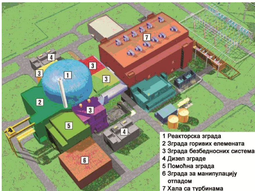
Слика 2.2.2.5-1.: Важније зграде реакторског блока EPR [5]
