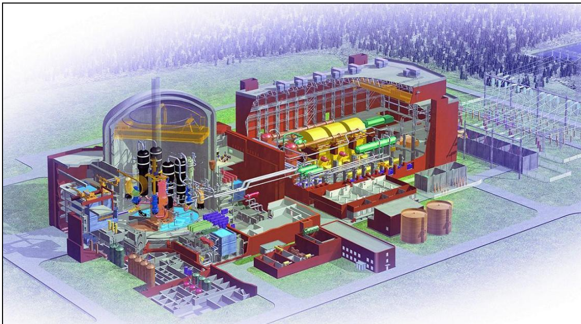
Слика 2.4.1.4-1.: Приказ блока EPR који се гради у Олкилуту <Olkiluoto> у Финској [19]
