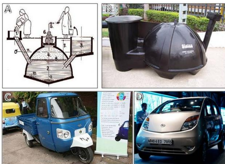
29. ábra Egy indiai családi méretű biogázfejlesztő „folyamatábrája” (A) és a kereskedelemben kapható modernizált változata (B). Hidrogénhajtású háromkerekű haszongépjármű (C) és szintén hidrogénhajtású „népautó” (D).
